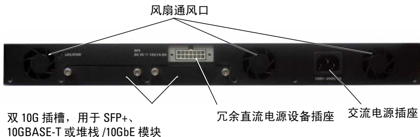
图 1-9. PC7024P 和 PC7048P 背面板
